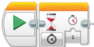
Первый вариант езды по ультразвуковому датчику – использовать блок ожидания:
