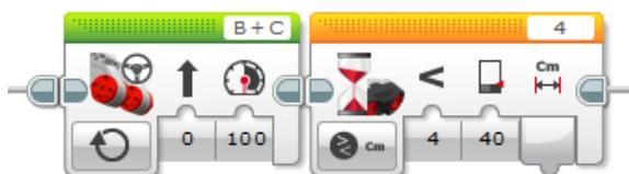
Второй вариант езды по ультразвуковому датчику – использовать цикл с постусловием:
